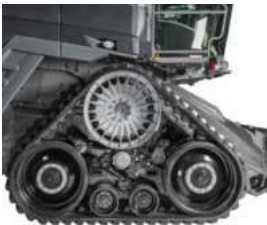
Os rastros TrakRide garantem uma pressão excepcionalmente baixa sobre o solo.
