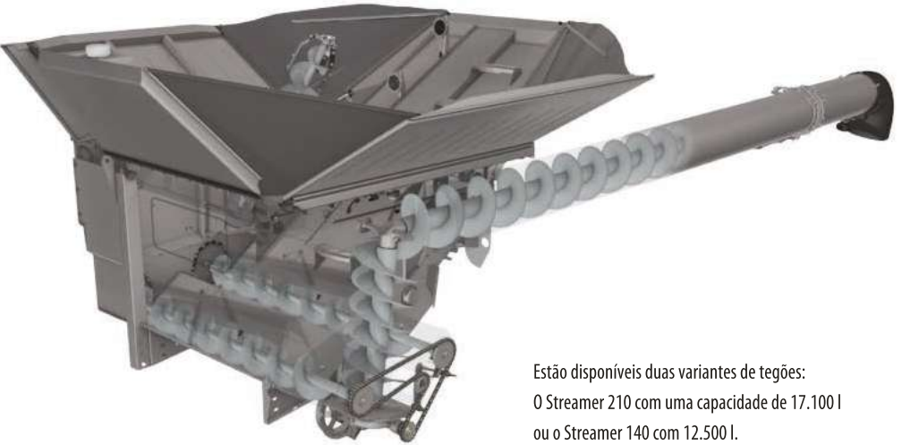
Uma boa visão global do rendimento, humidade e qualidade é sempre fornecida graças aos dados em tempo real do campo: Sensores para rendimento e humidade, bem como câmara com qualidade para os grãos, são montados no elevador. Os dados têm uma precisão de 98% e são utilizados graças ao padrão VarioDoc ISOBUS, mapeamento de produção ao vivo e IDEALharvest™.
