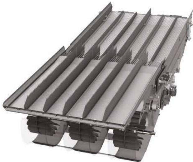
As 6 barras centrais medem 150 mm de altura para uma insensibilidade de inclinação de até 15 graus. Sensores de perda no final da sapata ajudam a ajustar a máquina para a melhor configuração possível.
