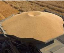
Capacidade de 17,100 l no Streamer 210 descarrega em cerca de 81 segundos.
