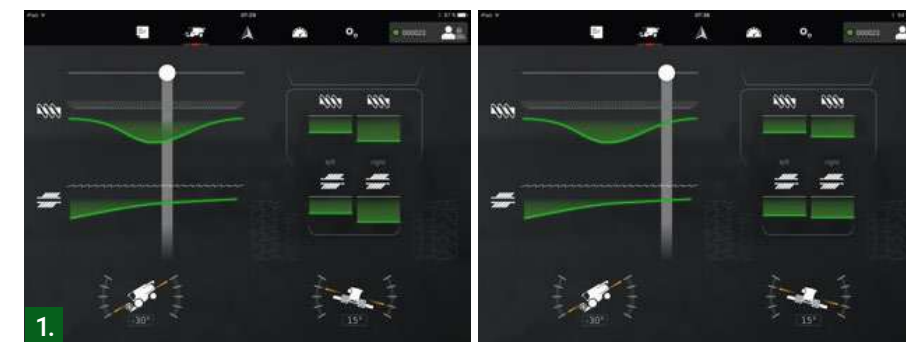
Детальний вигляд завантаження рослинної маси: в оператора є огляд зліва / справа із задньої частини комбайна. Переміщуючи повзунок вздовж блоку обробки рослинної маси, можна візуалізувати завантаження рослинної маси в кожній зоні.
