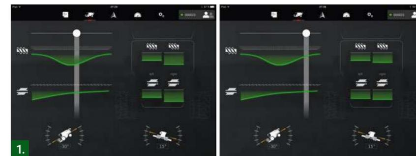
Vista detallada de la carga de cultivo: el operario dispone de una vista izquierda/derecha desde la parte trasera de la cosechadora. Moviendo el control deslizante a lo largo del procesador, es posible visualizar la carga de cultivo en cada zona.
