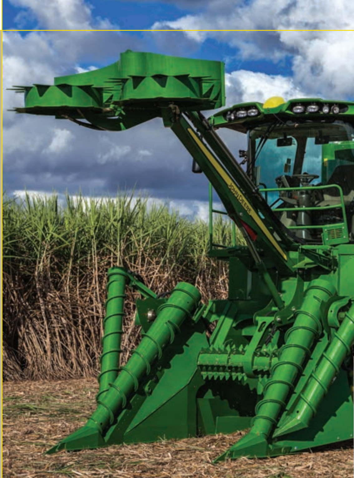
O rolo levantador aberto minimiza a presença e o acúmulo de impureza mineral.
