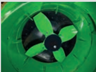
Extrator primário de quatro hélices, com 152 cm de diâmetro: o maior do mercado
