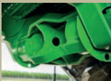
O rolo levantador aberto minimiza a presença e o acúmulo de impureza mineral.
