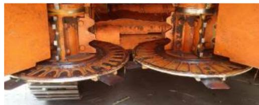
Montados na plataforma de colheita, há dois conjuntos de cortes de base com discos e facas que realizam o corte da cana rente ao solo. Os discos e as facas são padrão de mercado, o que facilita a reposição.
