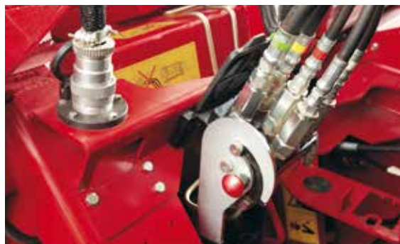
Dank Multikuppler für die Hydraulikfunktionen ist das Ankoppeln des Vorsatzes in wenigen Minuten erledigt
