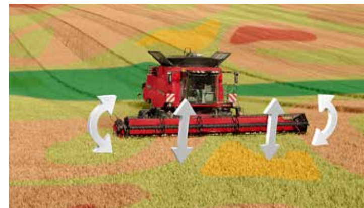
La tecnología Terrain Tracker de Case IH garantiza el mantenimiento de una altura de corte exacta en la mayoría de los campos irregulares.
