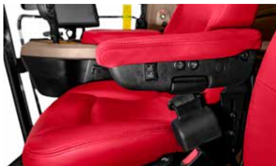
El asiento de suspensión neumática o el asiento de piel semiactivo, calefactado y ventilado con controles alcanzan niveles de confort de lujo como en un automóvil
