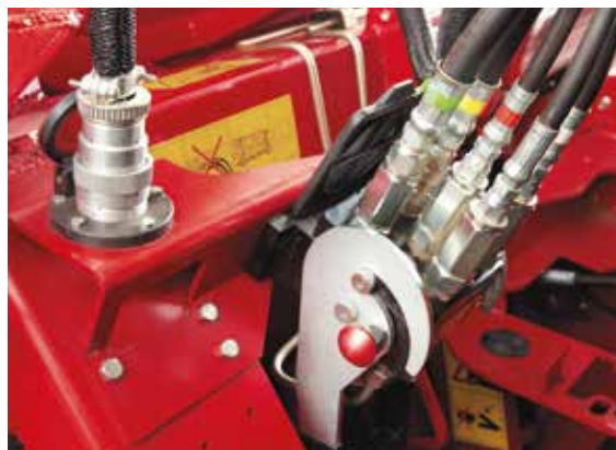
Monta el cabezal en cuestión de minutos utilizando el cierre único que conecta todos los servicios hidráulicos
