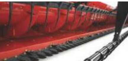
Plataforma de grãos: sem fim de maior diâmetro, com dedos retráteis em toda a sua extensão
