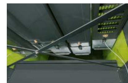
Wartungsöffnungen am Ende der Schüttler gewähren Ihnen einen schnellen, werkzeuglosen Zugang.
