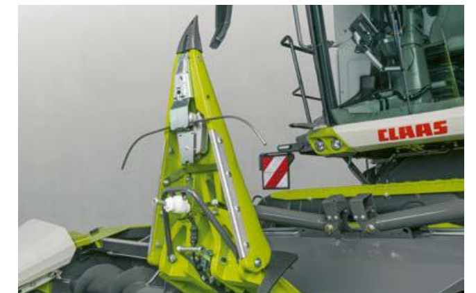
Zwei Tastbügel tasten je eine Maisreihe ab.
