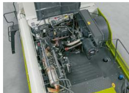
Cummins-Motor mit AdBlue-Abgasnachbehandlung (Stage V)
