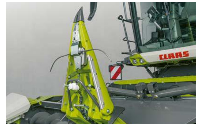
Dos palpadores palpan cada hilera de maíz.
