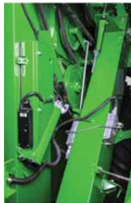
Sensores montados nos elevadores de grãos mensuram a produtividade e a umidade dos grãos colhidos.
